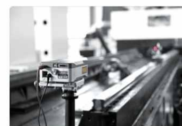
雷射干涉仪检测走行绝对精度 Precision coordinate measuring instrument.
