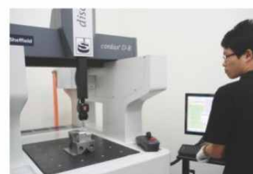
利用3次元检测零件精度 Laser to check accurate positioning
